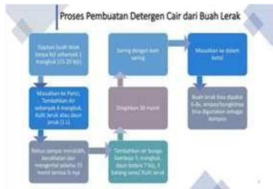
Gambar 2 Proses Pembuatan Detergen Cair dari Lerak
